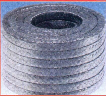
**G-SPECIJAL** je pletenica za zaptivanje vretena armature izrađena od ekspandiranog grafitnog prediva i ojačana tankom inconel žicom (0.15mm)
