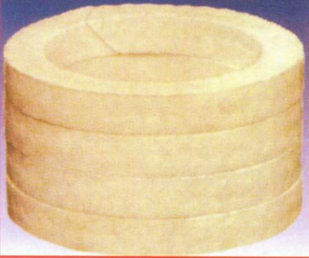
**ALCHEM** se sastoji od čistih predimpregniranih PTFE-vlakana. Zbog posebno čvrstog prepletanja ALCHEM ima samo neznatna svojstva kompresivnosti. ALCHEM se odlikuje neznatnim stepenom naleganja i jako velikom stabilnošću oblika, i zato se pre svega primjenjuje u plunzer pumpama i armaturama. Pletenica postiže sa Kf+ 10-20m<sup>2</sup> najpovoljnije vrednosti zaptivanja, koje su moguće kod pletenica.
