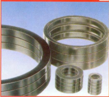
U proseku proizvodnje po MERKEL patentu, grafitna traka se specijalnom metodom profilise da bi se obezbedilo ravnometerno presovanje prstenova i izbegli uključici i mehurići. U standardni program spadaju prstenovi gustine od 1,2 do 1,9 g/cm<sup>3</sup>, prilagođeni radnom pritisku i sili pritezanja.
